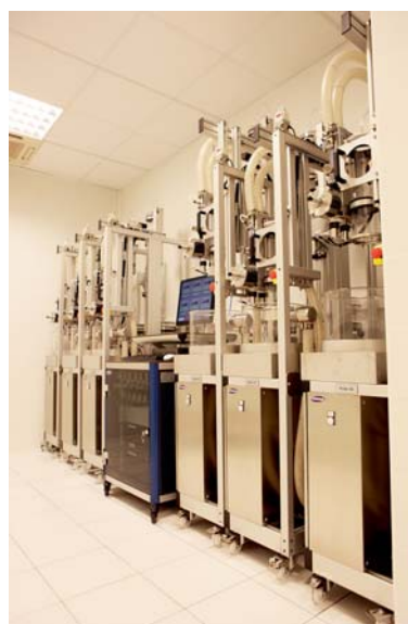
Source CARMAT - Salle d'endurance des systèmes complets, pouvant accueillir jusqu'à 12 systèmes en environnement contrôlé.
